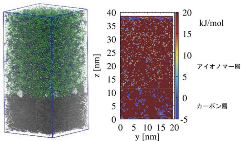
図 2-2-1-B-4. (左) モデル電極界面の全原子 MD 計算、
