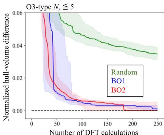
図 2-2-1-A-2. 形成エネルギーの凸包に対する DFT 計算回数に関する収束挙動。BO1、BO2 はそれぞれターゲット変数を形成エネルギー、hull-distance としたときのベイズ最適化を表す。
