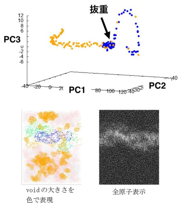
図 2-2-1-C-4. MODYLAS による高分子材料の引っ張り変形の MD 計算データに TDA を適用して 3 つの主成分値で可視化。
