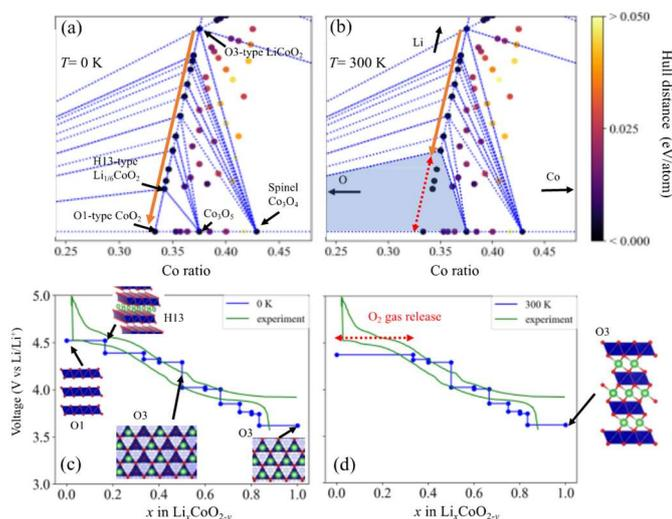
図 2-2-1-A-3. (a) 0 K と (b) 300 K における Li-Co-O 相の凸包、(c) 0 K と (d) 300 K における電圧プロファイル。オレンジ色の矢印は  $\text{LiCoO}_2$  から  $\text{CoO}_2$  への理想電荷反応方向、青色の斜線領域は 3 相分離領域であることを示す。
