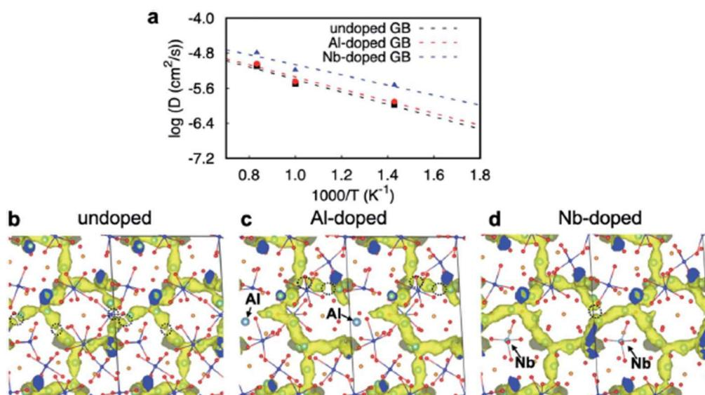
図 2-2-1-A-6. (a) 固体電解質  $\text{Li}_7\text{La}_3\text{Zr}_2\text{O}_{12}$  の  $\Sigma 3(112)$  粒界付近のドーピングなし、Al ドーピング、Nb ドーピング系に対する自己拡散係数の計算値。Nb ドーピングにより自己拡散係数が向上することが示唆された。(b-d) ドーピングなし、Al ドーピング、Nb ドーピング系の Li イオン分布。Al ドーピング系では Li 伝導パスが切断されている。
