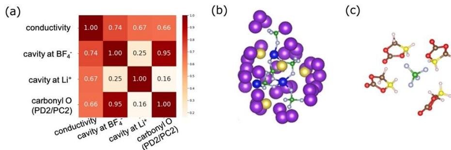
図 2-2-1-A-4. (a)  $\text{LiBF}_4/\text{EC}$  系におけるマイクロ構造とイオン伝導度の相関マップの例。
