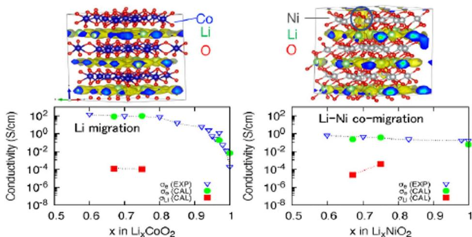
図 2-2-1-A-1. (上) LiCoO<sub>2</sub> 及び LiNiO<sub>2</sub> の結晶構造と Li 分布。
