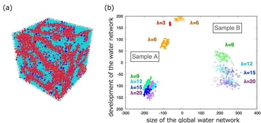
図 2-2-1-A-5. (a) 含水 Nafion の相分離構造 (赤 : 高分子の疎水部、青 : 高分子の親水部、水色 : 水相)。
