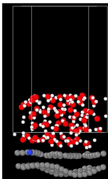
図 2-2-1-B-3. 水/N-doped graphdiyne/graphene でのシミュレーションモデル
