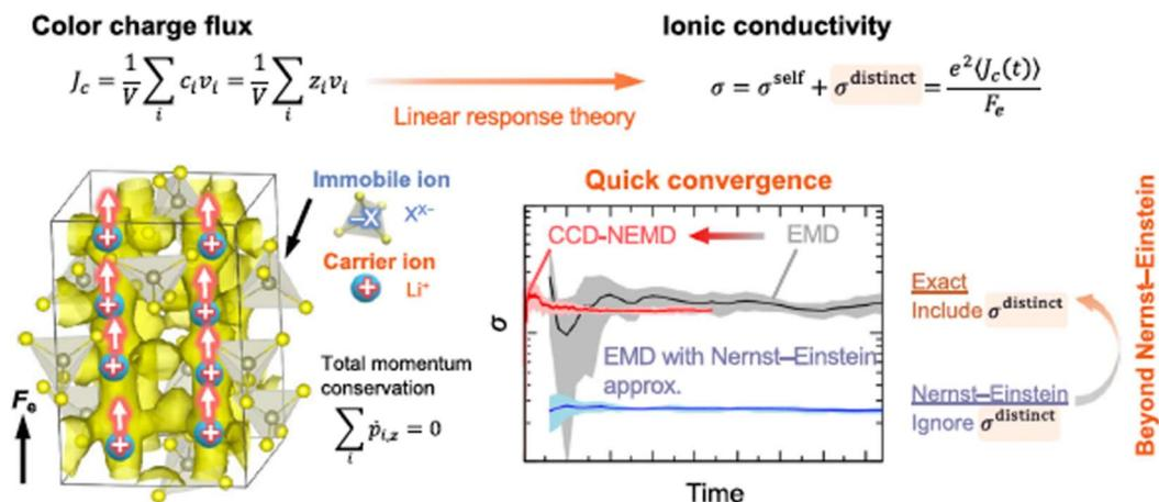
図 2-2-1-A-8. (左)  $\text{Li}_{10}\text{GeP}_2\text{S}_{12}$  モデル系における Li イオン、アニオンユニットの電荷およびカラー電荷フラックスの定義。
