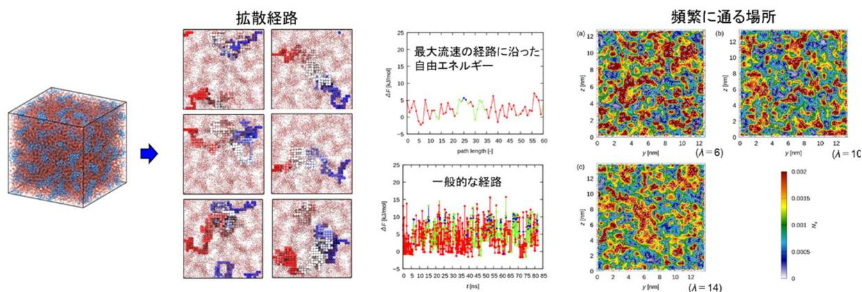
図2-2-1-B-5. 新規動的モンテカルロ法により生成した水素分子の高分子電解質膜中の大域的な軌跡と、軌跡から抽出した拡散経路の特徴。
