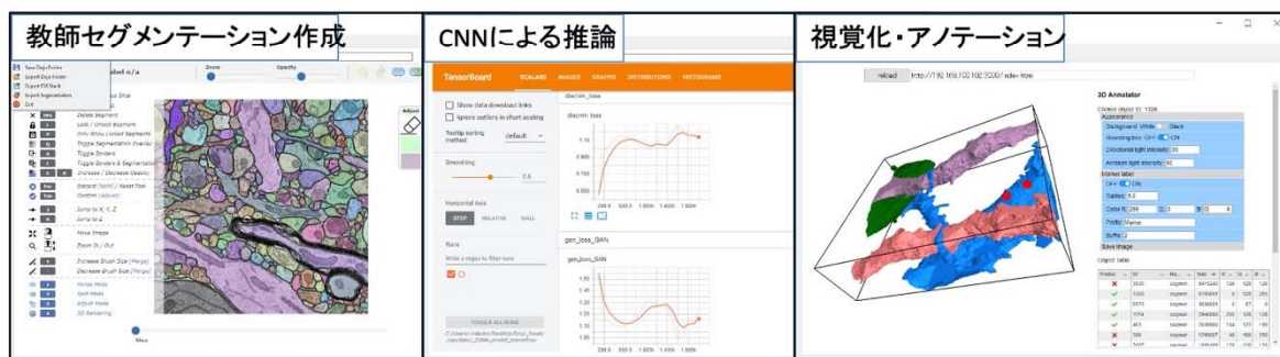
図 A3 : 電子顕微鏡画像にもとづく神経細胞 3 次元構造再構成を行う統合ソフトウェア UNI-EM の概要。教師データ作成、CNN による推論、視覚化・アノテーションのパイプライン上を往來する統合環境によって、3 次元構造再構成作業の省力化を実現した。
