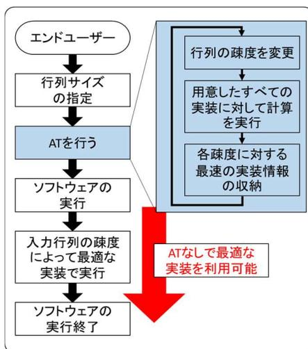
図 d-2: 尾崎の方法に AT を適用する場合の処理の流れ
