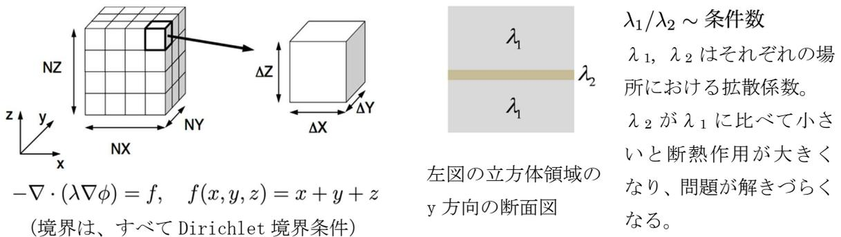
図 a-1: 解析モデル（3次元 Poisson 方程式）
