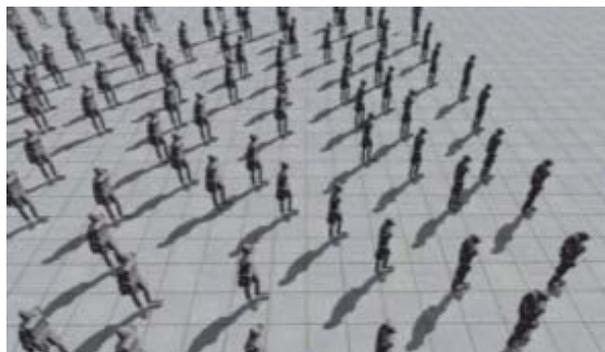
図 E1：MatcherNet を用いた二足歩行者群衆シミュレーション。26 関節のそれぞれに力学系ノードを割り当てた全身ロボットキャラクタ最大 500 体をシミュレーション環境下で動作させた。
