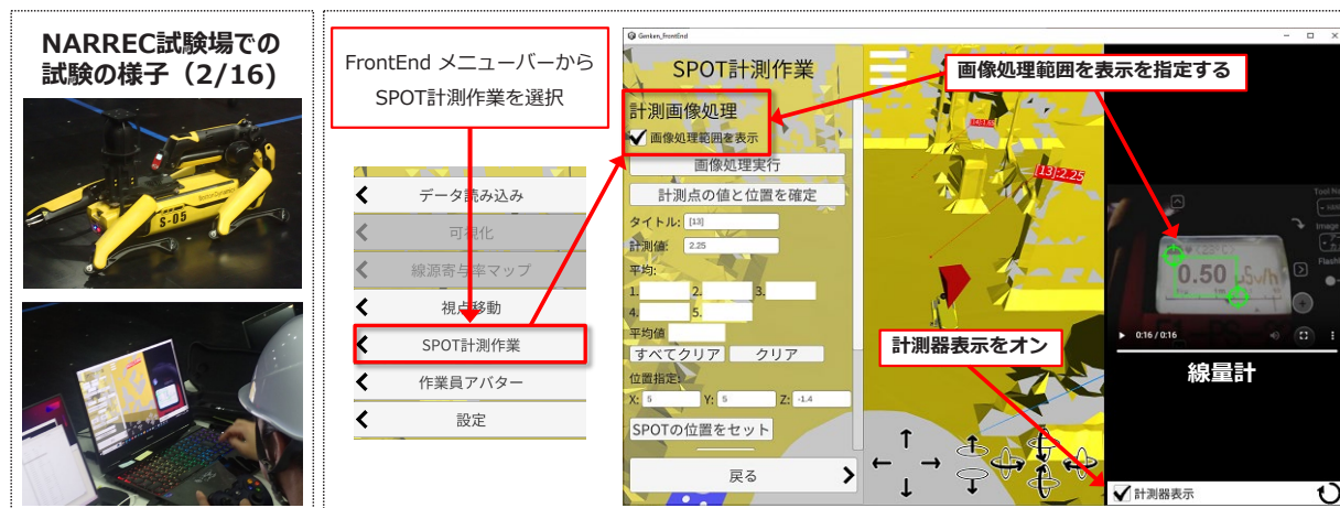
図6 再観測指示機能が動作し、線量率を再観測する際の線量計自動認識画面スナップショット（左図はNARREC試験場での本動作試験の様子、右図は、自動認識画面であり、再右端に線量計の画面情報と数字枠を指定し、線量値を記録する）
