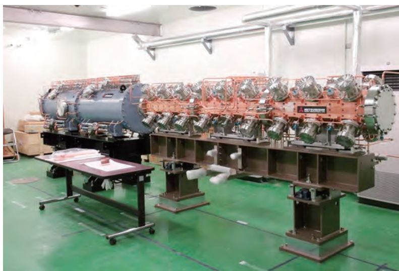
図3 「いばらき中性子医療研究センター」内の加速器室に設置したRFQ+DLT加速管
