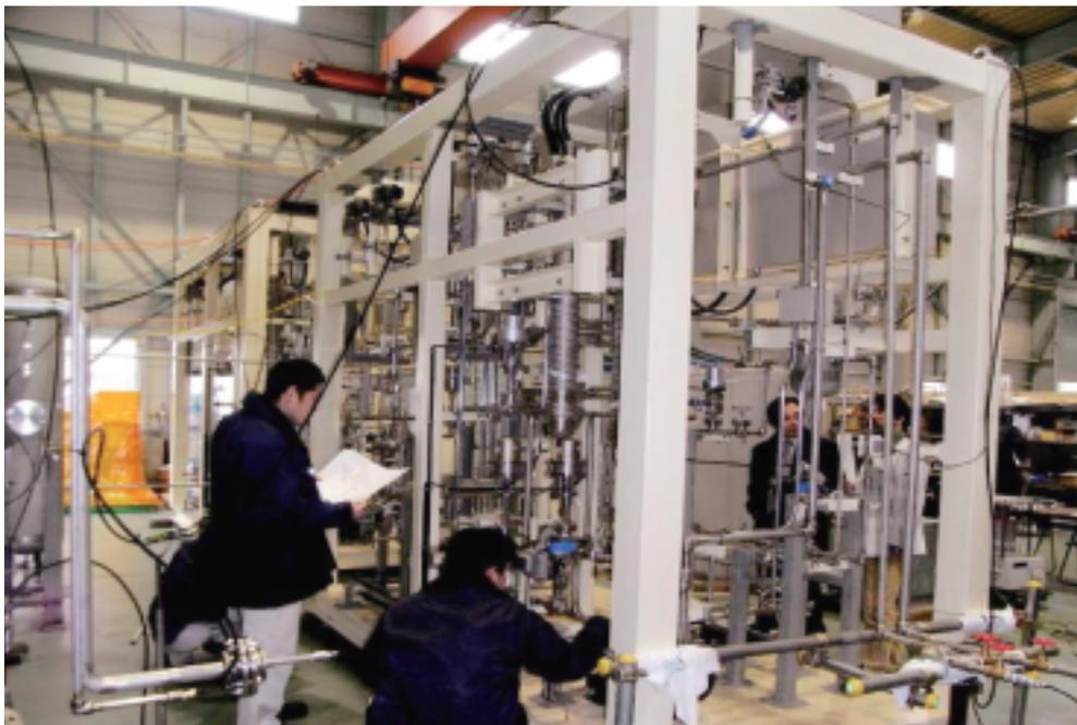
図6 六ヶ所サイトの原型炉R&D棟に設置されたトリチウム取扱設備のためのトリチウム除去系の製作
