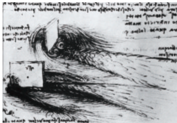
図3. レオナルドダビンチによる流れに置かれた物体まわりの乱流のスケッチ
