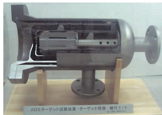
図16 ADSターゲット実規模模擬モデル
