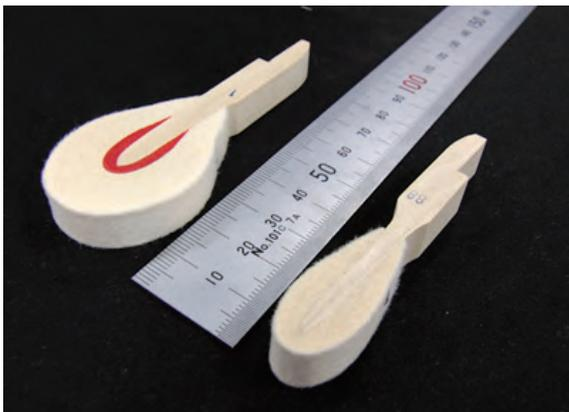
図6 ピアノハンマー (左:低音用, 右:高音用)
